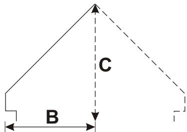
In tabelul alaturat veti gasi valorile suprafetei maxime de acoperis care poate fi drenata cu un singur burlan, calculate in conditiile unei inclinari a jgheabului de 3% (3 mm la un metru liniar de jgheab) si cu o intensitate a ploii de 75 mm/h.
